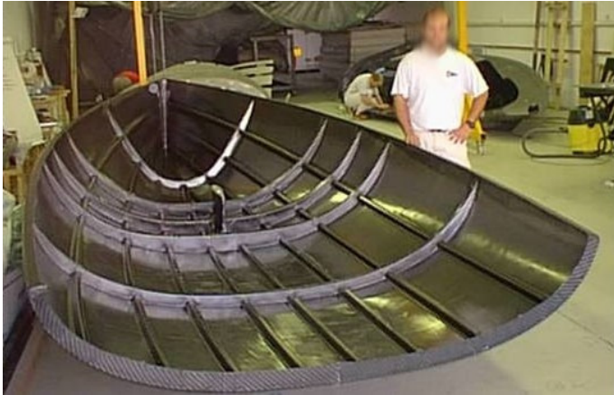
Coque de bateau à base de préimprégnés carbone. Process développé au CRITT Mécanique & Composites.
